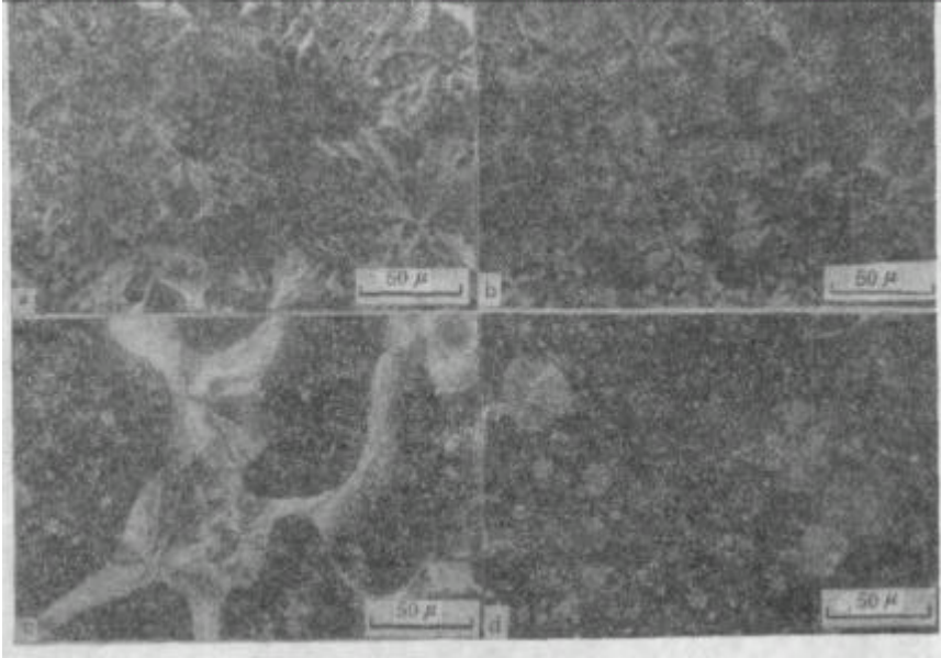
图 3 不同 PSF 含量的 UC-PPS/PSF 共混样品的织态结构 (PLM). PSF 含量: a, 10%; b, 25%; c, 50%; d, 75%
